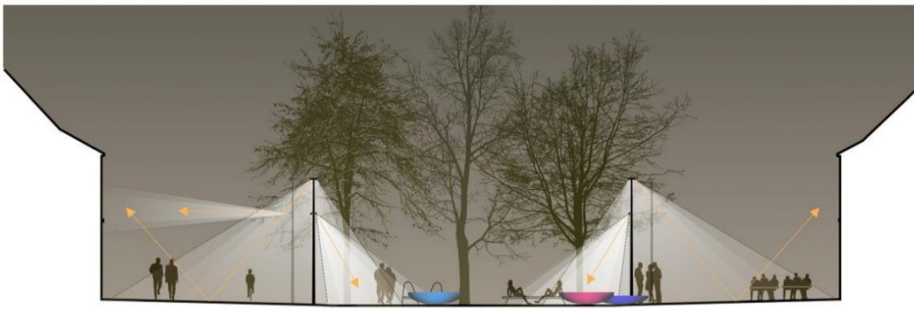
Akzentierung einzelner Fassadenelemente über Strahler am Masten
